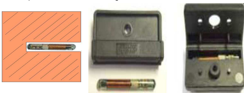
Figura Nº 11 Instalación de Tag's
