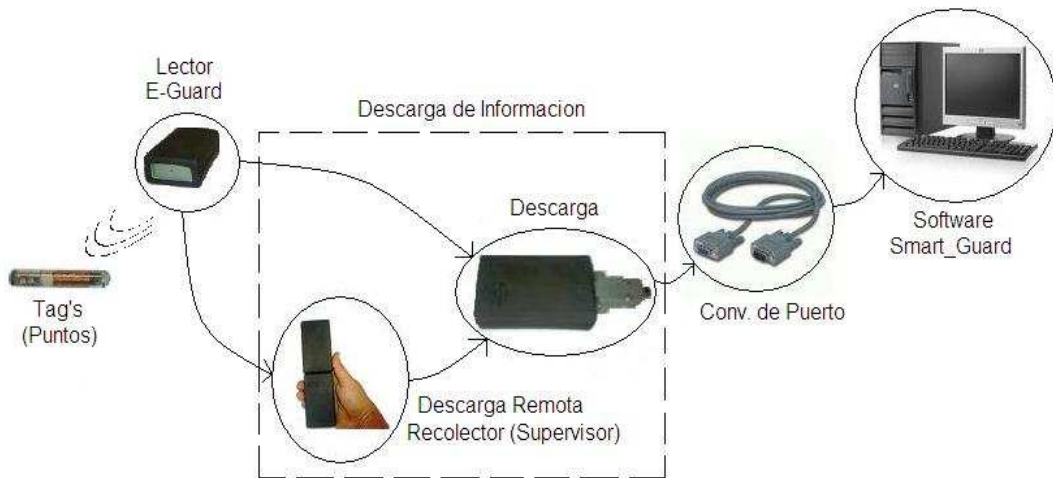
Fig. N° 1. Arquitectura del Control de Rondas.
